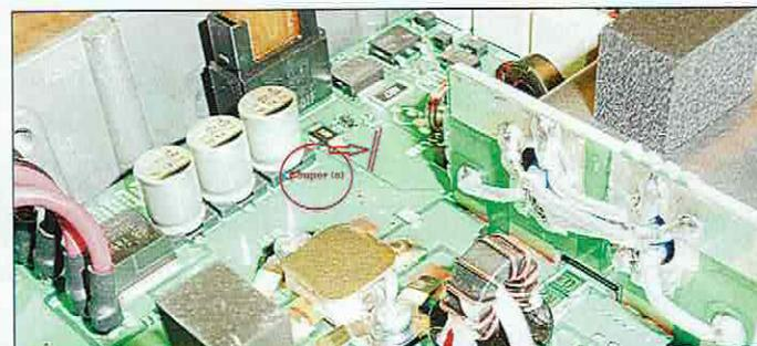
Photo N°9 : Côté PA, faire une coupure du circuit imprimé comme indiqué et décaper le vernis de chaque côté pour souder les pattes du contact du relais.
