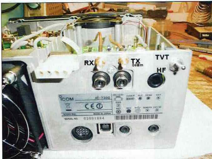
Photo N°6 : Vue de l'implantation des deux sub-clicks et du switch pour utilisation normale HF ou mode TVT en attente de câblage sur le relais RF.
