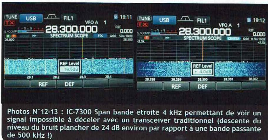
Photos N°12-13 : IC-7300 Span bande étroite 4 kHz permettant de voir un signal impossible à déceler avec un transceiver traditionnel (descente du niveau du bruit plancher de 24 dB environ par rapport à une bande passante de 500 kHz !)
